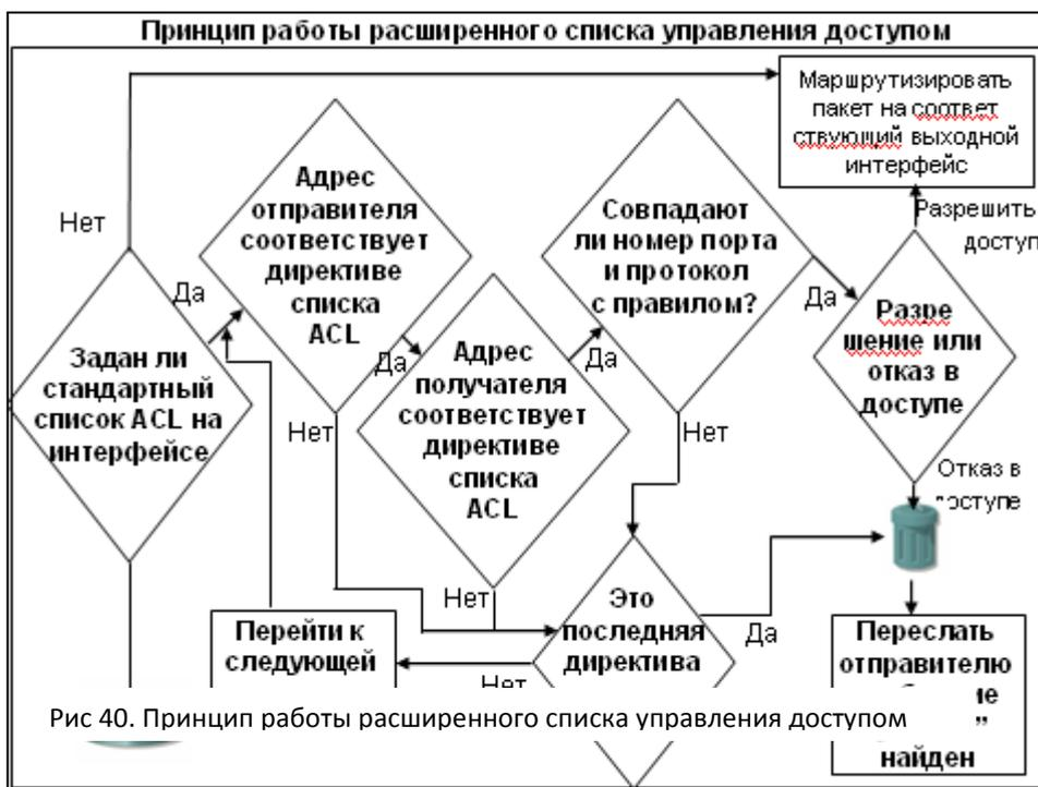
Расширенные списки управления позволяют более точно контролировать и управлять пакетами, нежели стандартные. Стандартные списки управления доступом предназначены для того, чтобы запрещать весь набор или стек протоколов; расширенные списки позволяют точно указать, какой из протоколов необходимо разрешить или запретить. Например, с помощью такого списка ACL можно разрешить трафик HTTP, но запретить доступ к ресурсам по протоколу FTP.
